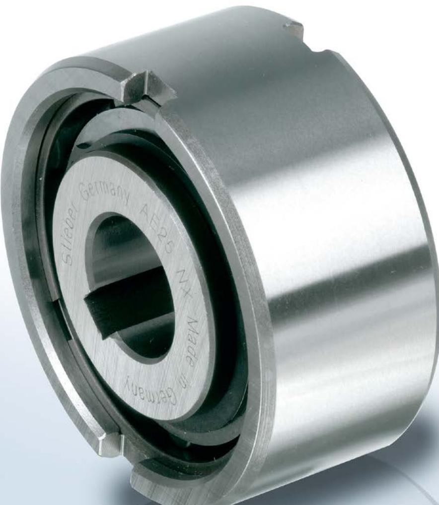
Модель AE представляет собой бесподшипниковую обгонную муфту роликового типа. Для восприятия осевых и радиальных нагрузок требуется установка подшипников. Кроме того, при установке должны быть обеспечены смазка и уплотнение муфты. Номинальный наружный диаметр соответствует размеру стандартного шарикоподшипника.
