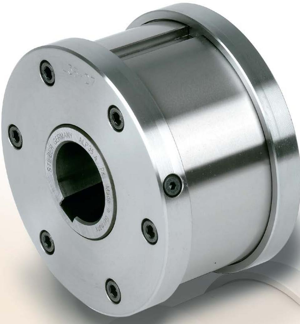
Модели ALP..F7D7 представляют собой муфты роликового типа, автономные, герметичные, на двух подшипниках серии 160. Не поставляется смазанная маслом. Эта комбинация крышек используется главным образом как обгонная или индексирующая муфта, как показано на следующей странице.
