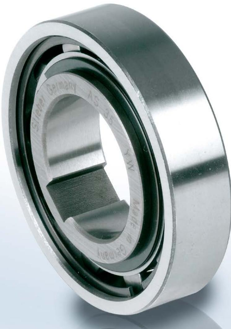
Модель AS представляет собой бесподшипниковую муфту роликового типа. Для восприятия осевых и радиальных нагрузок требуется установка подшипников. Кроме того, при установке должны быть обеспечены смазка и уплотнение муфты. Номинальные наружные размеры такие же, как у шарикоподшипников серии 62...
