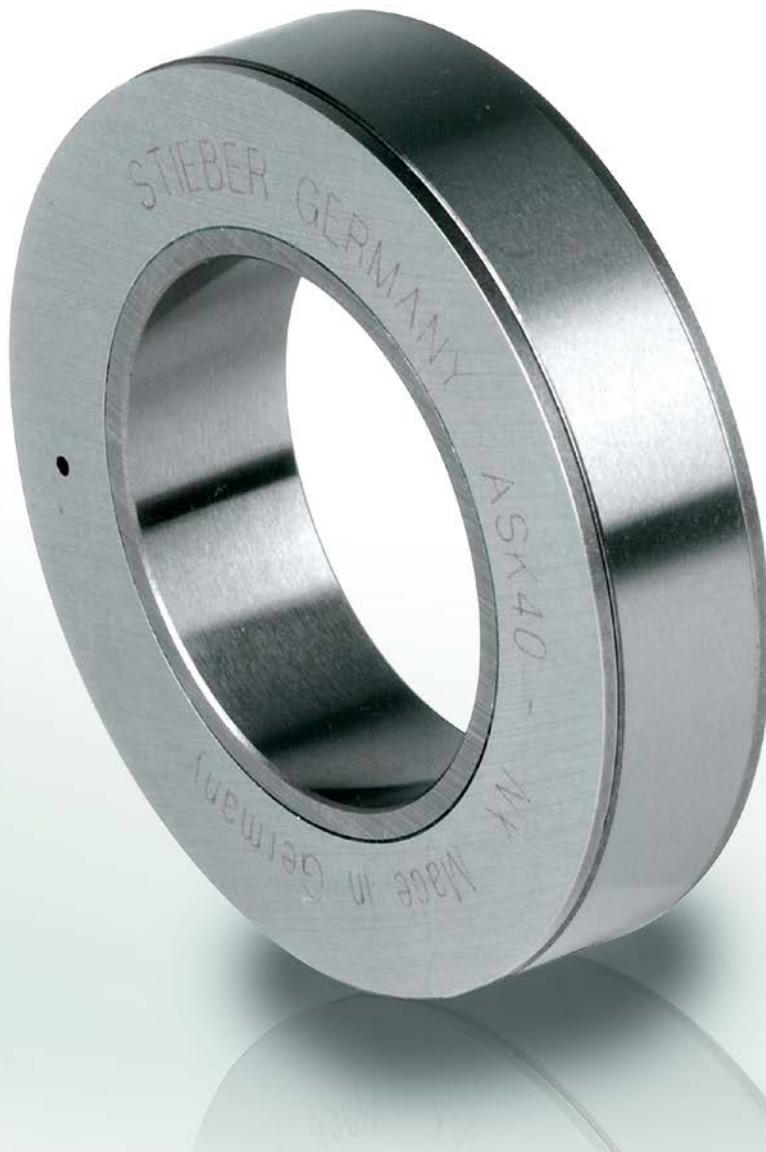
Модель ASK представляет собой обгонную муфту роликового типа с подшипниковой опорой в виде двухрядного роликоподшипника. Муфта является автономной, защищена от проникновения пыли, поставляется в смазанном виде с использованием консистентной смазки.
