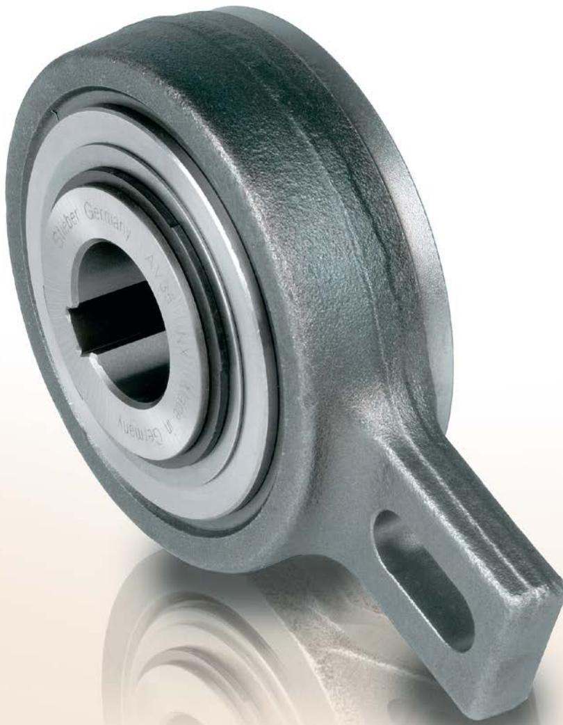
Модель AV представляет собой обгонную муфту роликового типа. Это автономная муфта с подшипниками скольжения для низких оборотов и лабиринтным металлическим уплотнением для герметизации.
