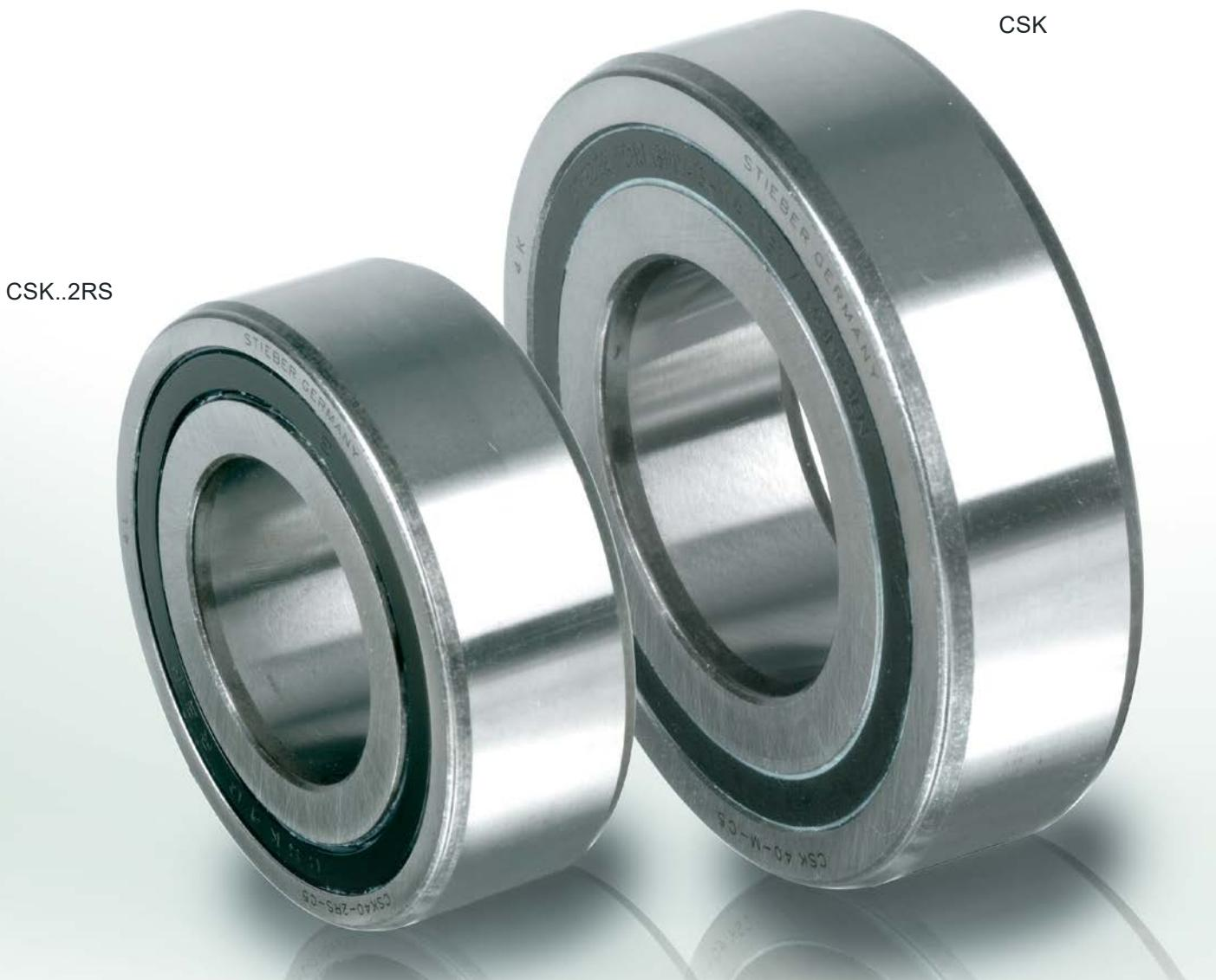
Модель CSK представляет собой обгонную муфту эксцентрикового типа, объединенную с шарикоподшипником серии 62 (кроме типоразмеров 8и 40). Она опирается на подшипник, поставляемый в смазанном виде с использованием консистентной смазки и защищена от проникновения частиц пыли размером более 0,3 мм. Рекомендуется использовать дополнительные уплотнения типа «nylos», особенно в случаях, когда рабочая температура превышает 50°C. Кроме того, можно использовать смазывание погружением в масляную ванну.
