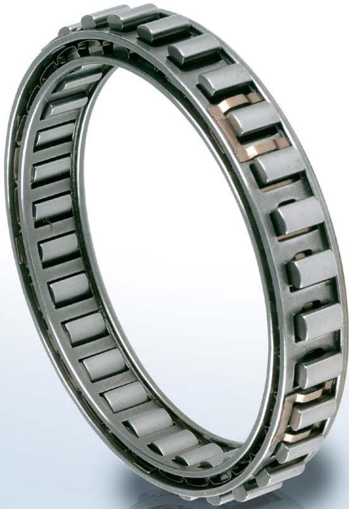
Модель DC представляет собой обгонную муфту экс-центрикового типа без внутреннего и внешнего кольца. Муфта устанавливается в конструкцию с кольцами и подшипниками для осевой и радиальной нагрузки. Муфта смазывается и герметизируется. Для модели DC исполнения N можно использовать все типы смазок, применяемых для силовых передач.
