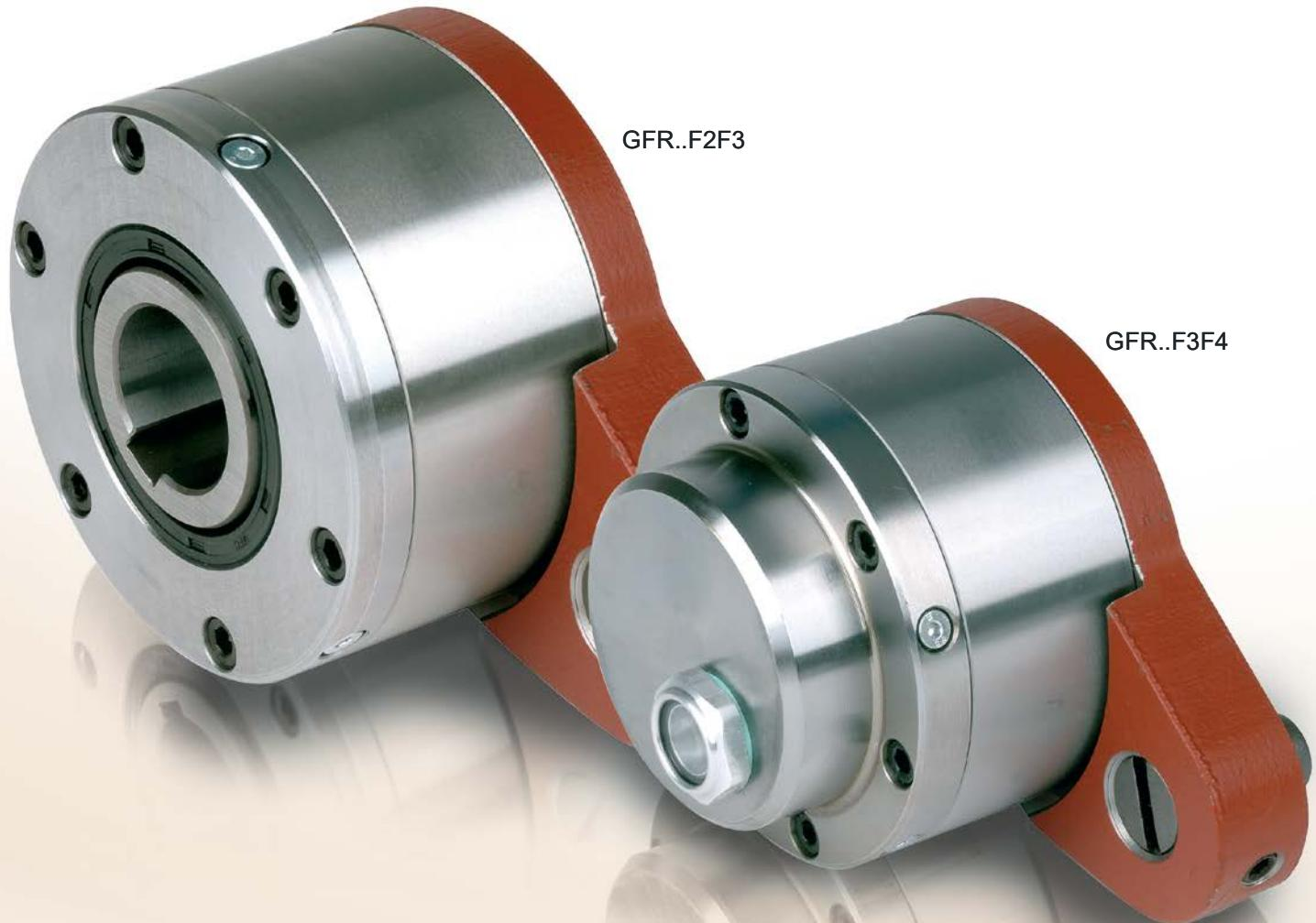
Модели GFR..F2F3/F3F4 представляют собой обгонные муфты роликового типа, автономные, герметичные, на двух подшипниках серии 160.
