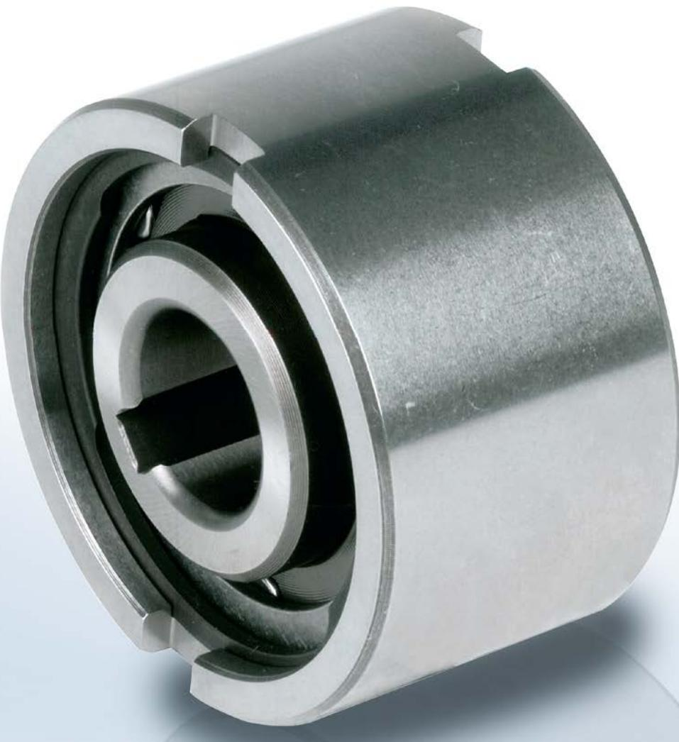
Модели NF представляют собой бесподшипниковые обгонные муфты роликового типа. Для восприятия осевых и радиальных нагрузок требуется установка подшипников. Смазка и герметики так же наносятся при установке.
