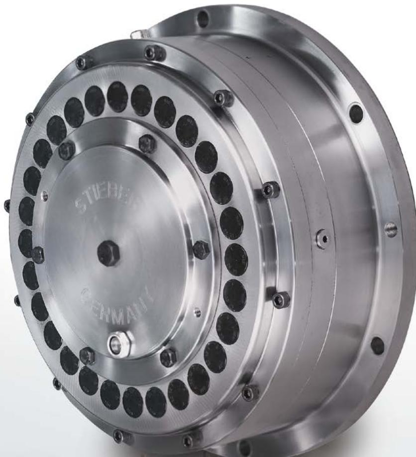
Тип RDBK является высокооборотным стопором обратного хода, см. на с. 72–75, имеющим в своей основе обгонную муфту с механизмом центробежного подъема эксцентриковых кулачков, совмещенную по внешней обойме с ограничителем крутящего момента
