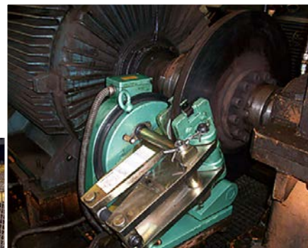
Sustitución por un freno electromagnético Stromag™
